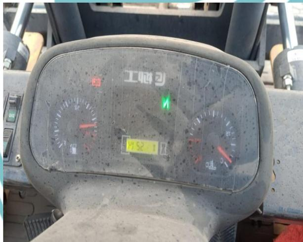
Gambar 2. Hour meter 521.4 jam
