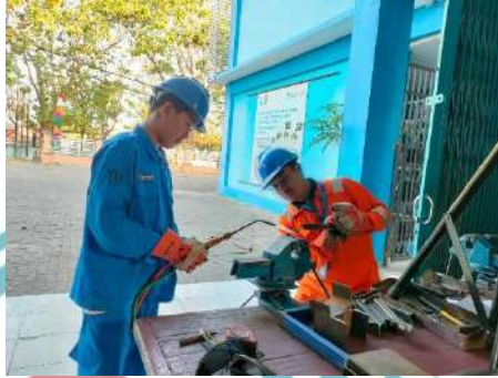
Lampiran 4. Membengkokkan besi menggunakan las asitilen
