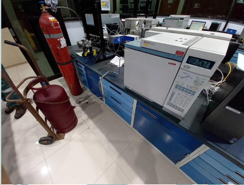
Gambar 1. Analisis LNG dengan Gas Chromatography
