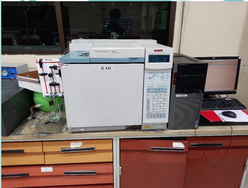
Gambar 2. Analisis LPG dengan Gas Chromatography
