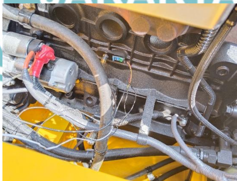
Penempatan sensor SW-420
