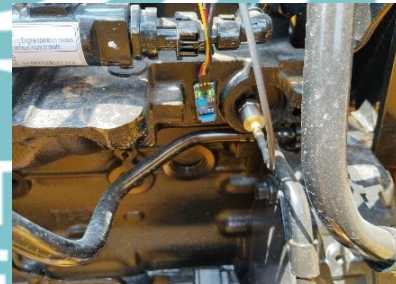
Pengujian menggunakan sensor SW-420
