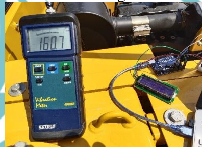
Pengujian menggunakan Vibration meter
