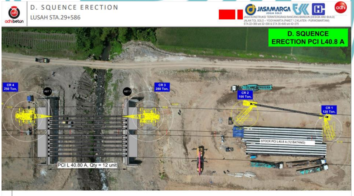
Gambar 4.2.4. 13 Proses Erection dan Peletakan Bearing Pad Pada Girder Ke-sepuluh
