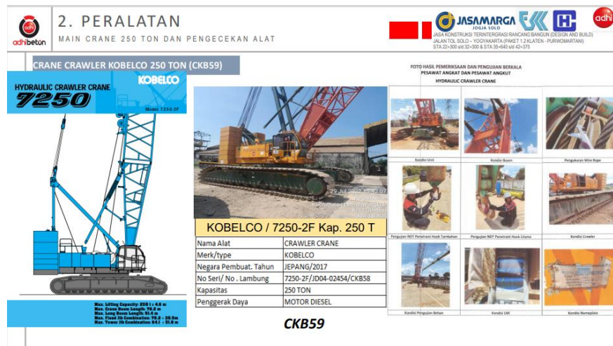
Gambar 4.2.2. 2 Crawler Crane 250 Ton
