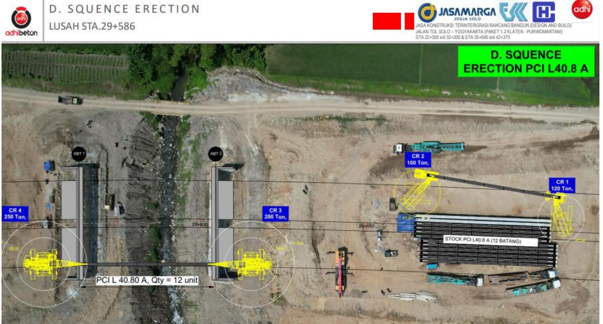
Gambar 4.2.4. 10 Proses Peletakan Girder Pada Bearing Pad Pertama
