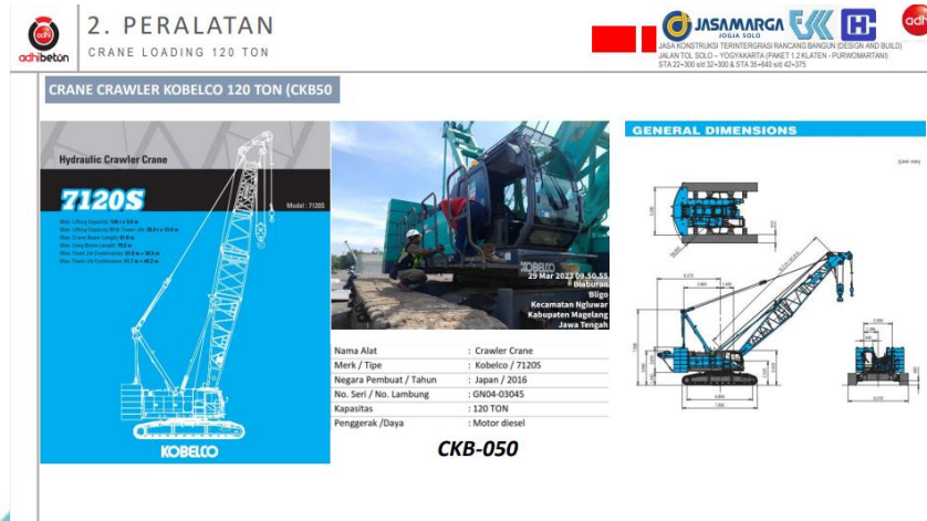
Gambar 4.2.2. 4 Crawler Crane 120 Ton
