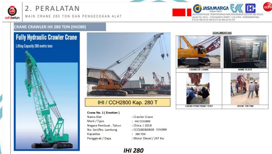
Gambar 4.2.2. 1 Crawler Crane 280 Ton
