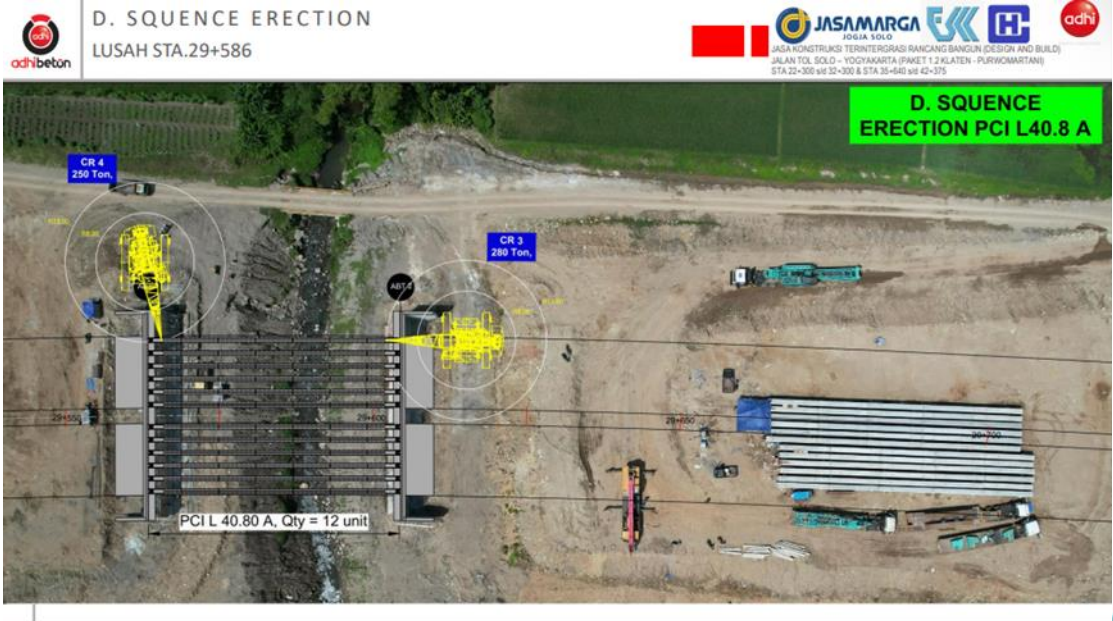
Gambar 4.2.4. 14 Proses Erection dan Peletakan Bearing Pad Pada Girder Ke-dua belas
