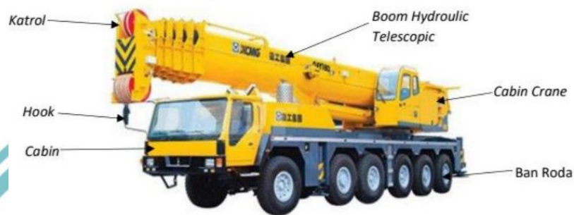
Gambar 2.4.2. 2 Bagian – bagian Mobile Crane
