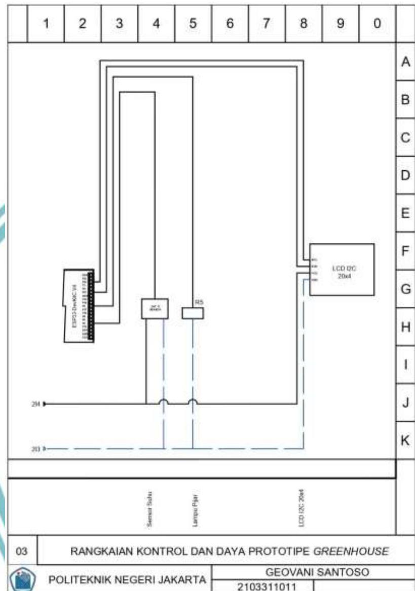
**Gambar 3.4** Diagram Kontrol dan Daya Protoype Greenhouse
