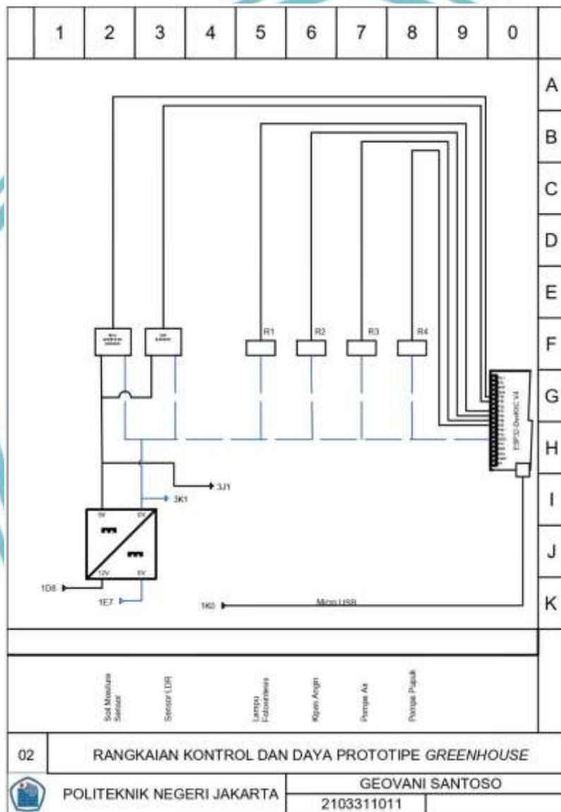
**Gambar 3.3** Diagram Kontrol dan Daya *Prototype Greenhouse*
