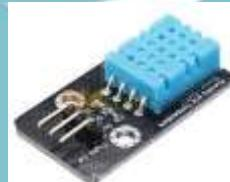
**Gambar 2.4** Sensor DHT11
