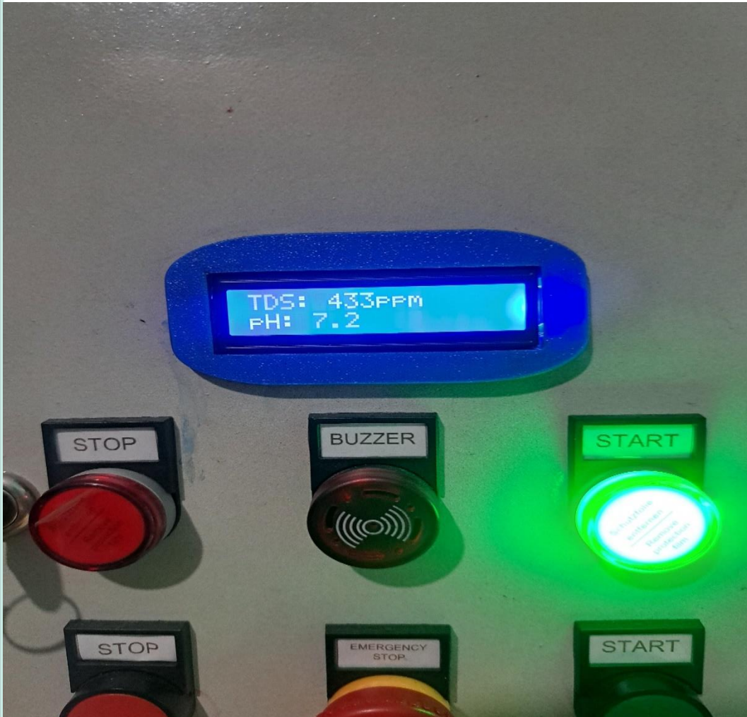
Lampiran 1 Tampilan LCD I2C saat membaca nilai ppm berdasarkan pembacaan sensor TDS
