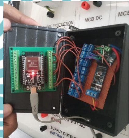
Gambar 7. Penempatan ESP32 dan komponen lain
