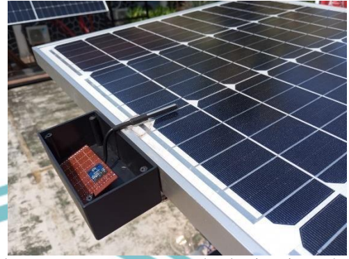
Gambar 6. Penempatan sensor suhu dan itensitas cahaya
