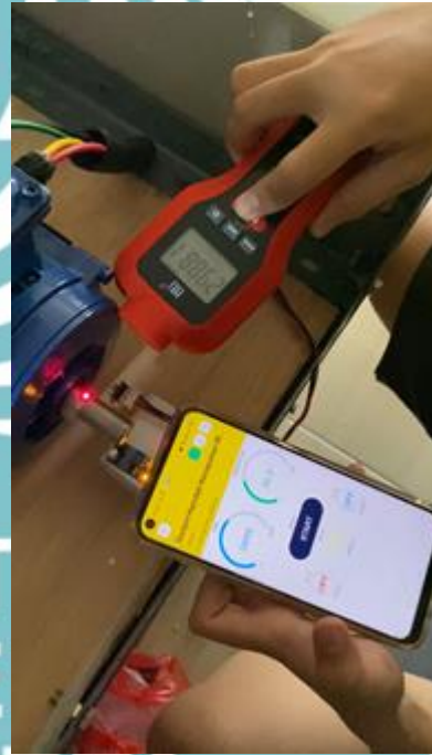
Membandingkan pembacaan RPM dengan Tacho meter dan penggunaan sensor IR speed FC-51
