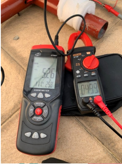
Pengecekan kecepatan angin dan tegangan yang dihasilkan Wind Turbine VAWT
