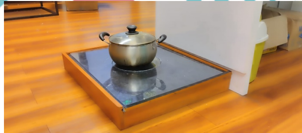
Hasil prototipe dari kompor induksi berbasis baterai
