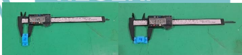
Gambar L.6 Pengukuran Objek 3D Level 4 menggunakan Jangka Sorong
