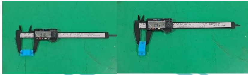
Gambar L.3 Pengukuran Objek 3D Level 1 menggunakan Jangka Sorong
