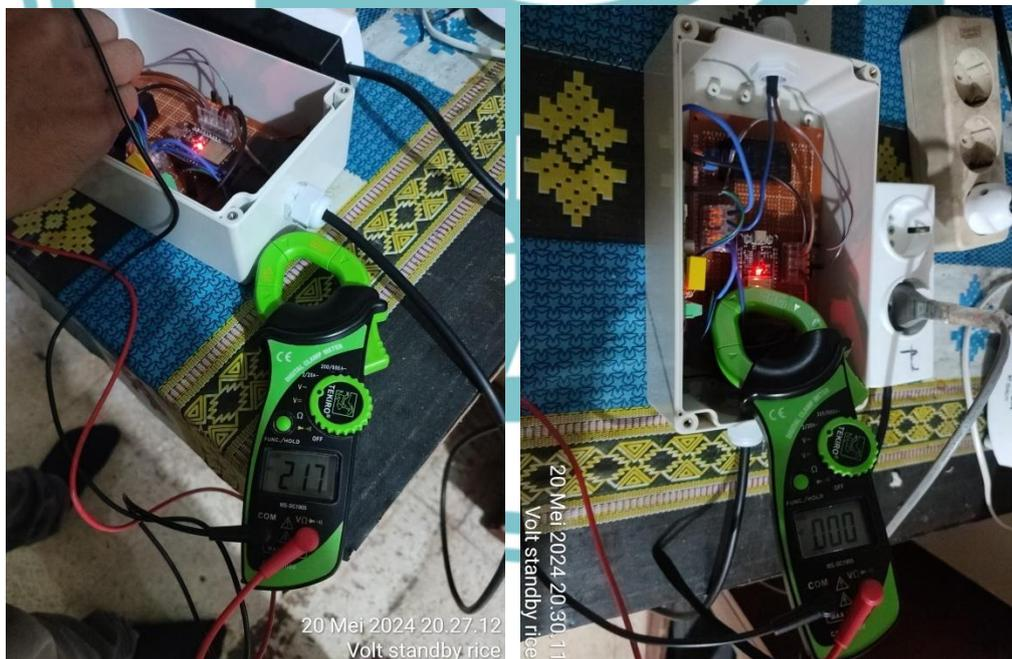
Gambar 4 22 Pengujian Menggunakan Tang Meter Saat Rice Cooker Standbay
