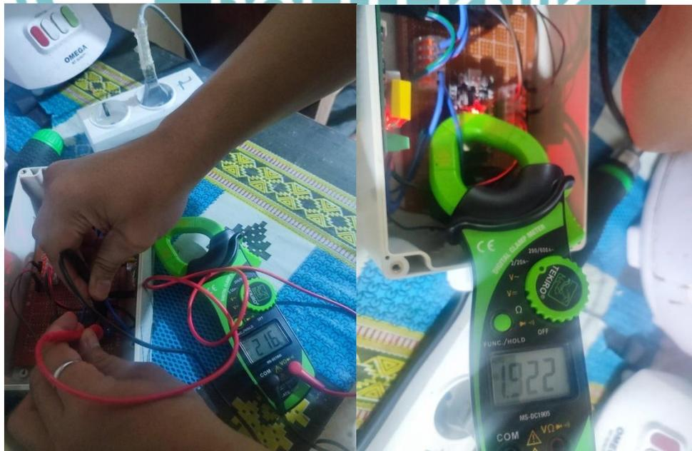
Gambar 4 25 Pengujian Menggunakan Tang Meter Saat Rice Cooker Bekerja
