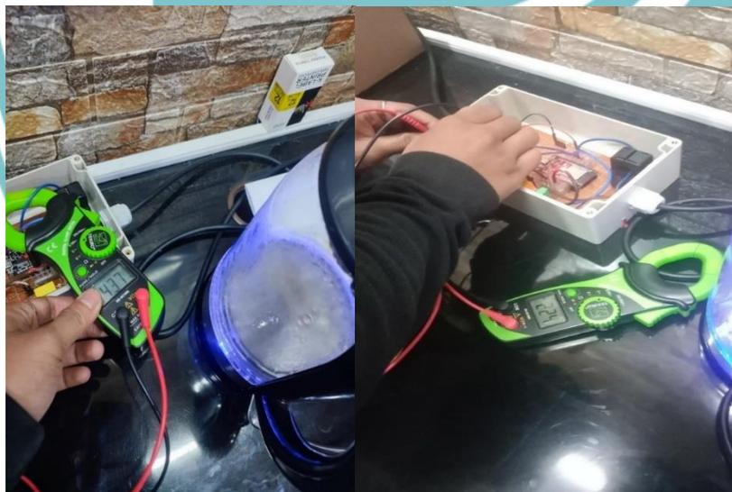
Gambar 4 37 Pengujian Menggunakan Tang Meter Saat Dispenser Bekerja
