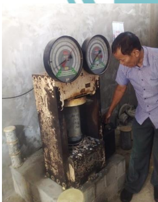
Gambar 4. 4. Pengujian Kuat Tekan Beton Sumber: Dokumen Pribadi
