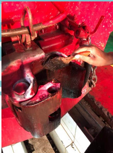
Gambar 3.14 Pengolesan Grease pada Coupler
