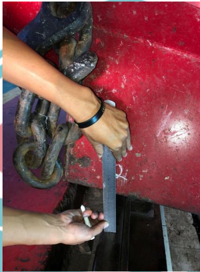
Gambar 3.11 Pengukuran Hanger Dengan Rel
