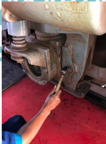
Gambar 3.12 Pemeriksaan Baut Roda
