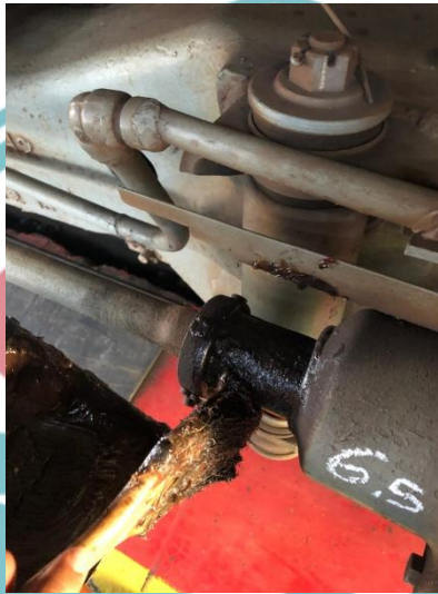
Gambar 3.13 Pengolesan Grease Torak Pengereman
