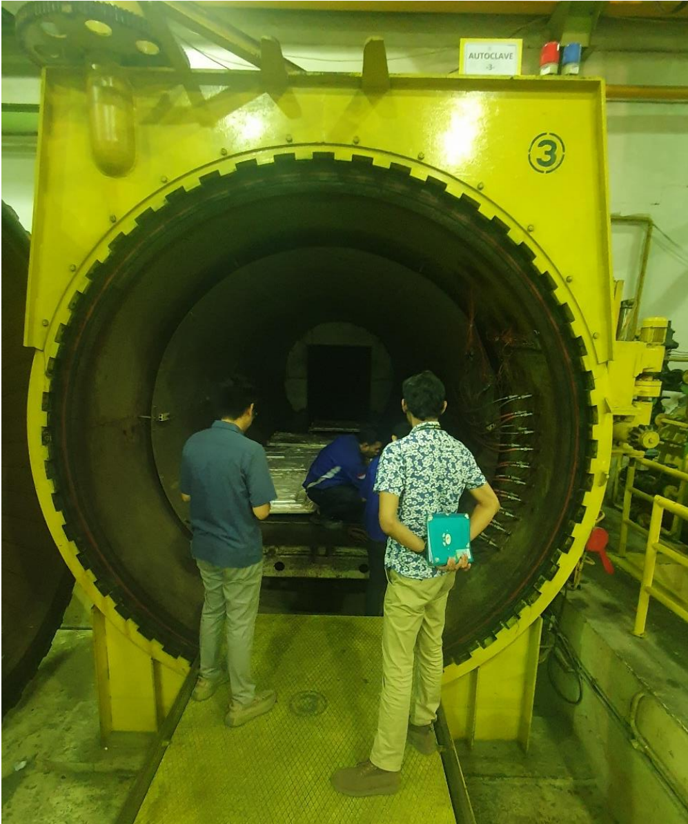
Lampiran 8. Dokumentasi Kegiatan Setting Thermocouple pada Mesin Autoclave
