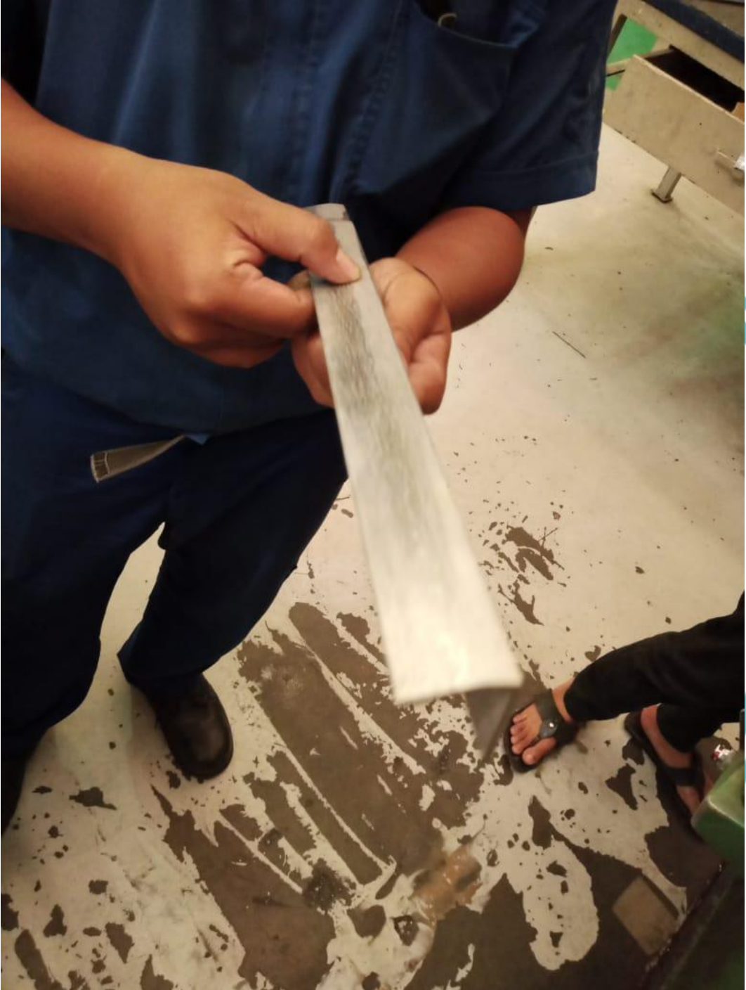
Lampiran 13. Hasil Proses Press Forming dari Part yang Sebelumnya Dilakukan Proses Heat Treatment
