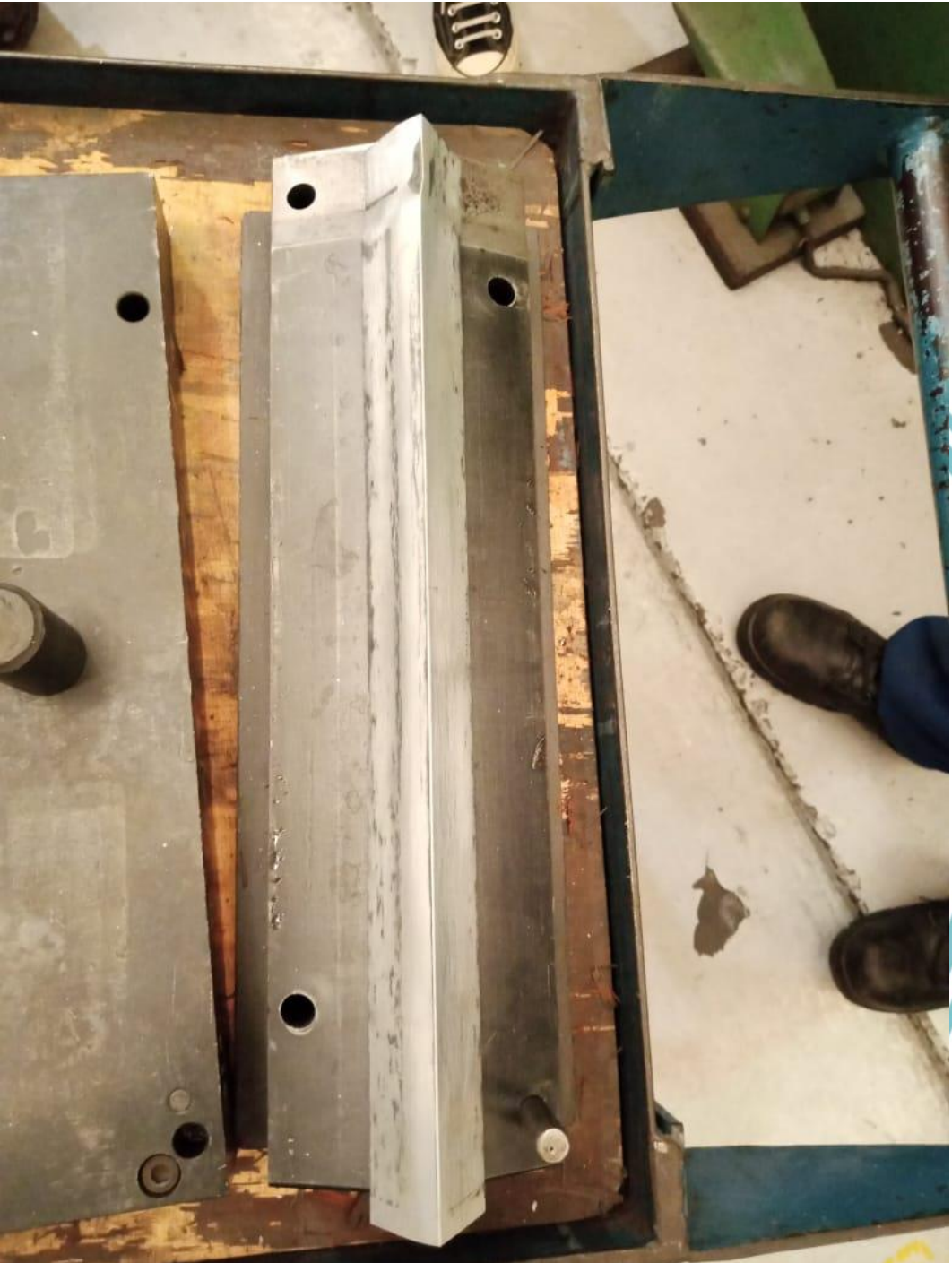
Lampiran 9. Hasil Part dari Hot Joggle Forming
