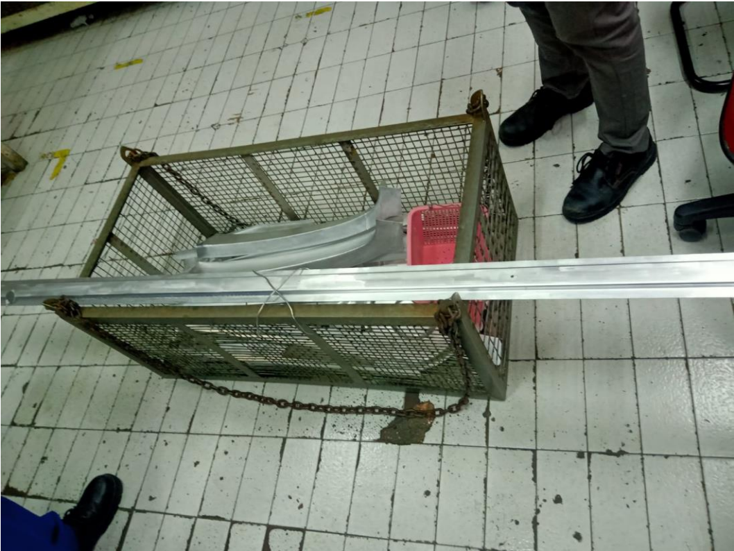
Lampiran 4. Racking Part untuk Menyelupkan Cairan Penetrant
