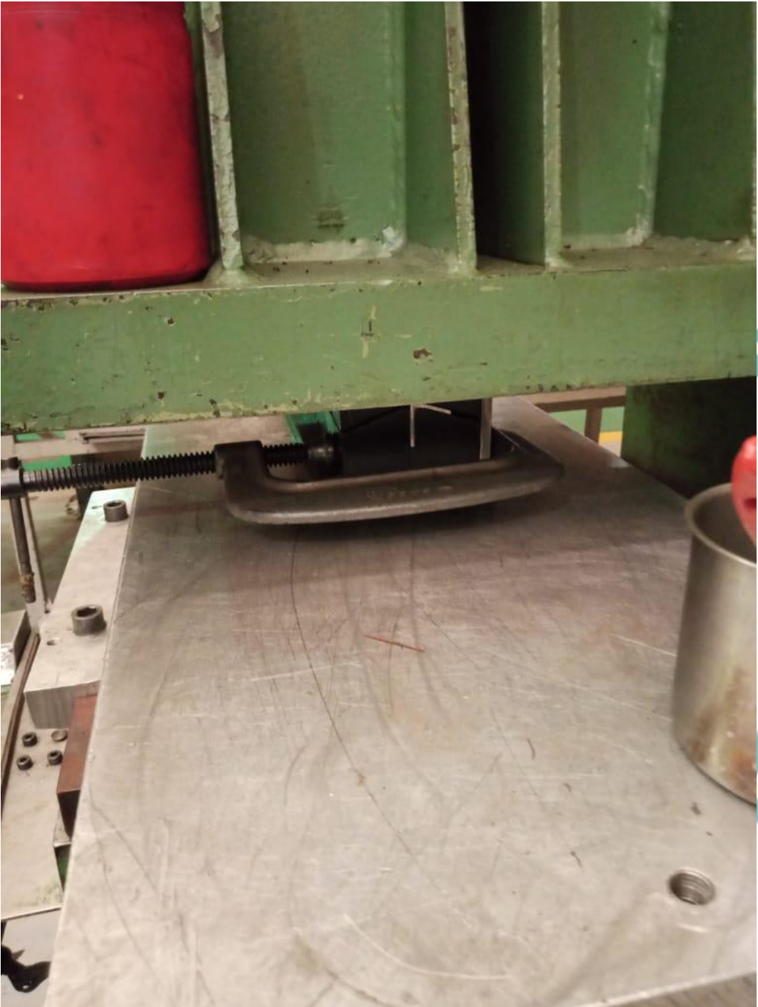
Lampiran 11. Penguncian Dies atau Cetakan pada Mesin Press
