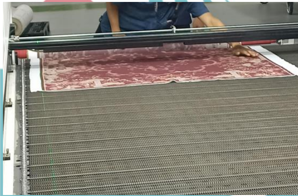
Gambar 3.25 Set-Up Posisi Kain pada Konveyor
