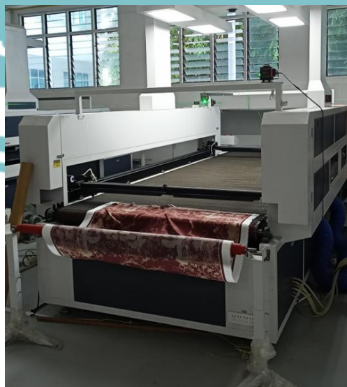
Gambar 3.29 Proses Kain Menuju Konveyor
