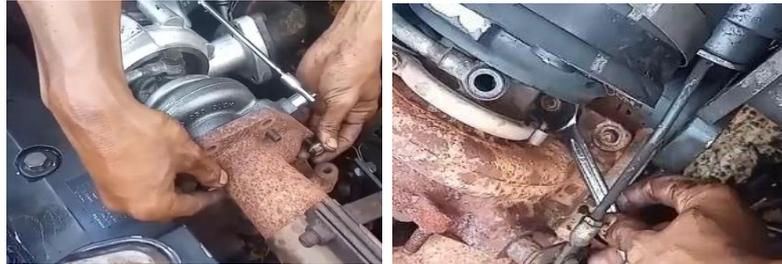
Gambar 9. Pembongkaran turbocharger
