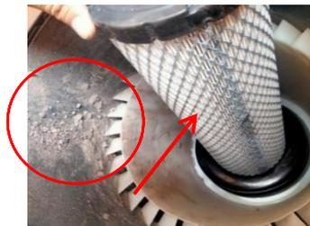
Gambar 7. Filter Udara Kotor
