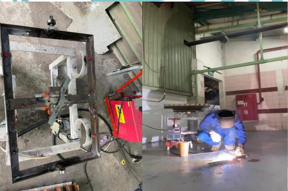
Proses perakitan alat bantu mesin packaging
