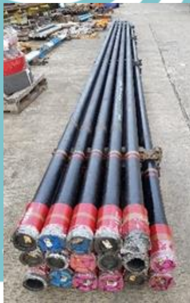
Gambar 1. 1 Pipa Coupling 3-1/2" Sumber: Dokumentasi Pribadi
