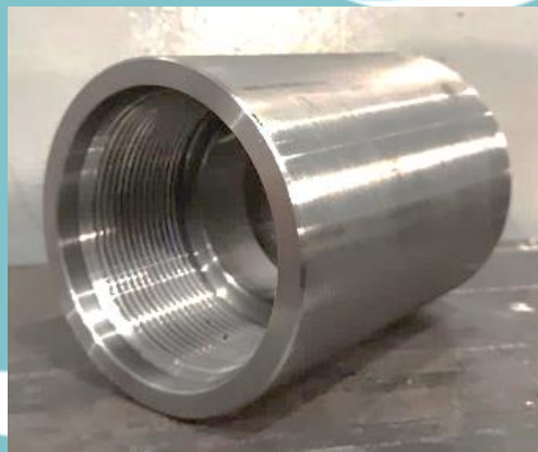
Gambar 1. 3 Coupling 3-1/2" Sumber: Dokumentasi Pribadi
