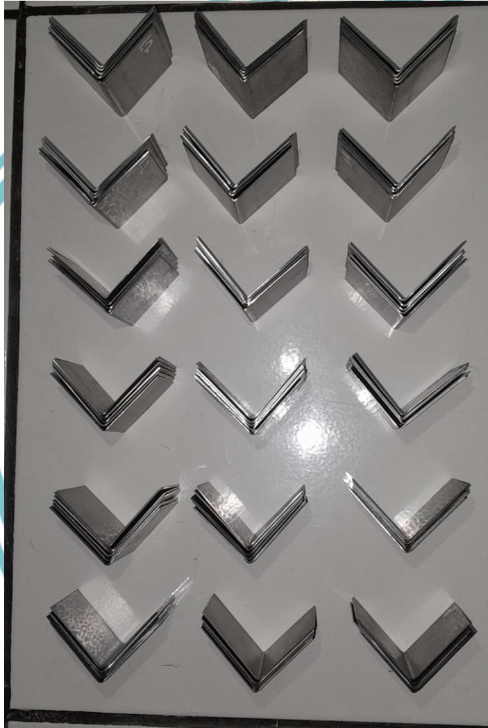
Gambar 5 1. Sampel hasil uji v-bending berjumlah 90 sampel
