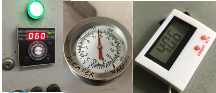
Penunjukan Temperatur yang berbeda antara termokontoler dan juga thermometer Suhu dinding luar 40,6 derajat celcius
