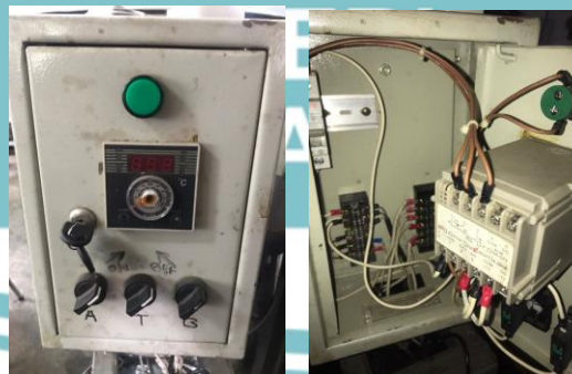
Panel kontrol memiliki kekurangan pada termokontroler dan belum memiliki alat pengatur waktu dan informasi daya
