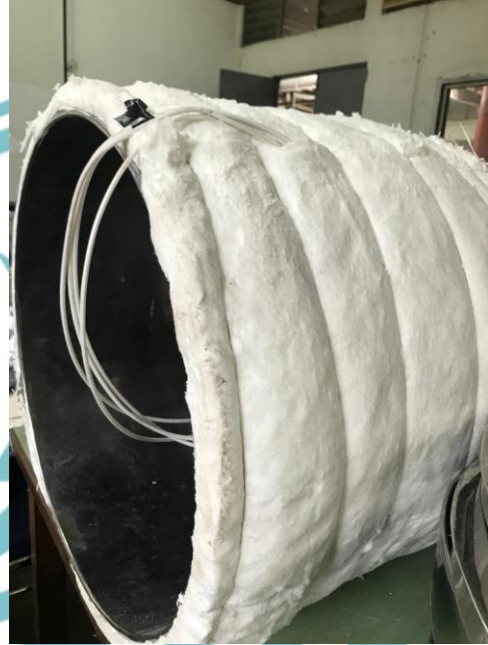
Proses pemasangan lapisan isolator pada dandang oven
