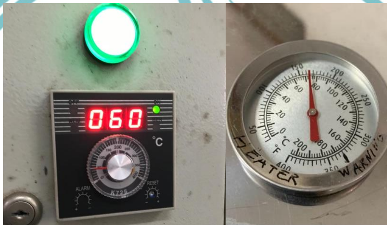
Gambar 1.3 Gambar Termokontroler dan Termometer yang Menunjukkan Suhu Berbeda Sumber: Arsip Pribadi
