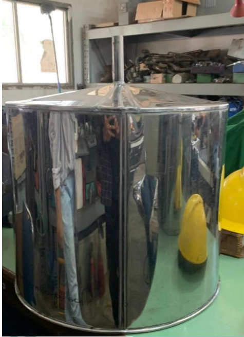
Proses pemasangan lapisan isolator pada dandang oven
