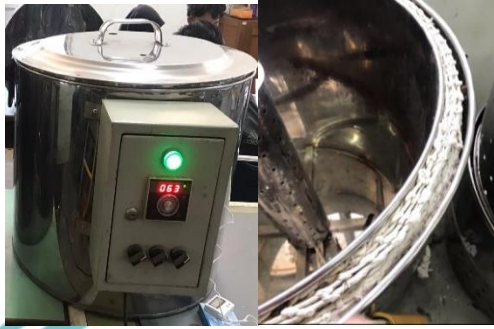
Gambar 1.1 Oven Existing atau Sebelum Dimodifikasi Sumber: Arsip pribadi
