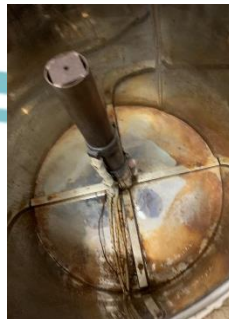
Gambar 1.2 Gambar Bagian Dasar Oven Berkarat Sumber: Arsip Pribadi
