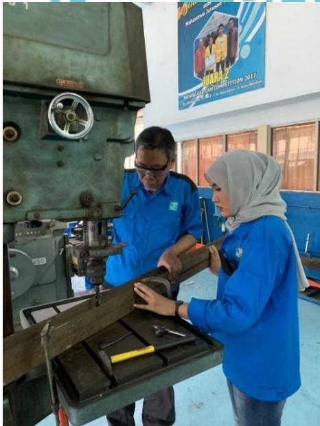
Proses pengboran pada rangka Turbin Angin
