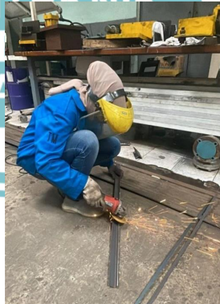
Proses gerinda pada rangka dari blade Turbin Angin
