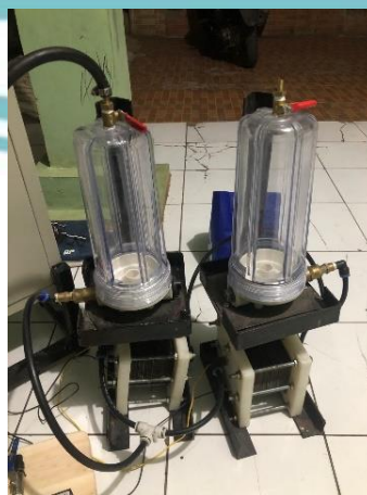
Gambar 3.12 Elektrolisis Dry cell dengan 2 tabung hydrogen dan oksigen
