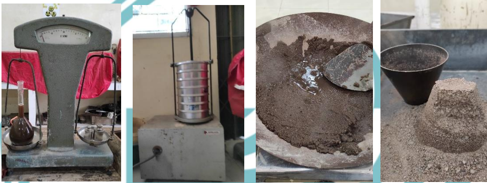
Proses Pengujian Agregat Halus dan Bottom Ash
