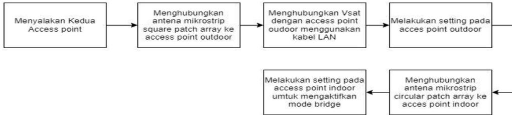
Gambar 4. 12 Diagram Blok Pengujian Keseluruhan Alat
