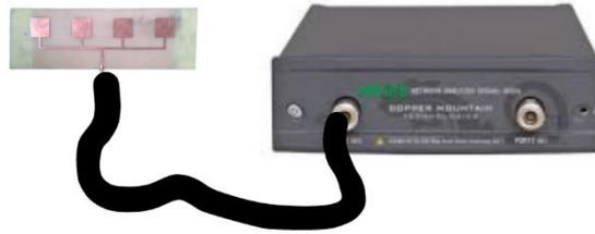
Gambar 4. 1 *Set-Up* Rangkaian Pengukuran Dengan *Network Analyzer*
