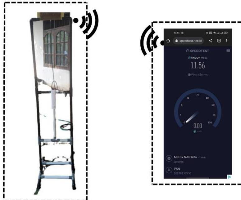
Gambar 4. 5 Set-Up Pengukuran Koneksi Internet VSAT
