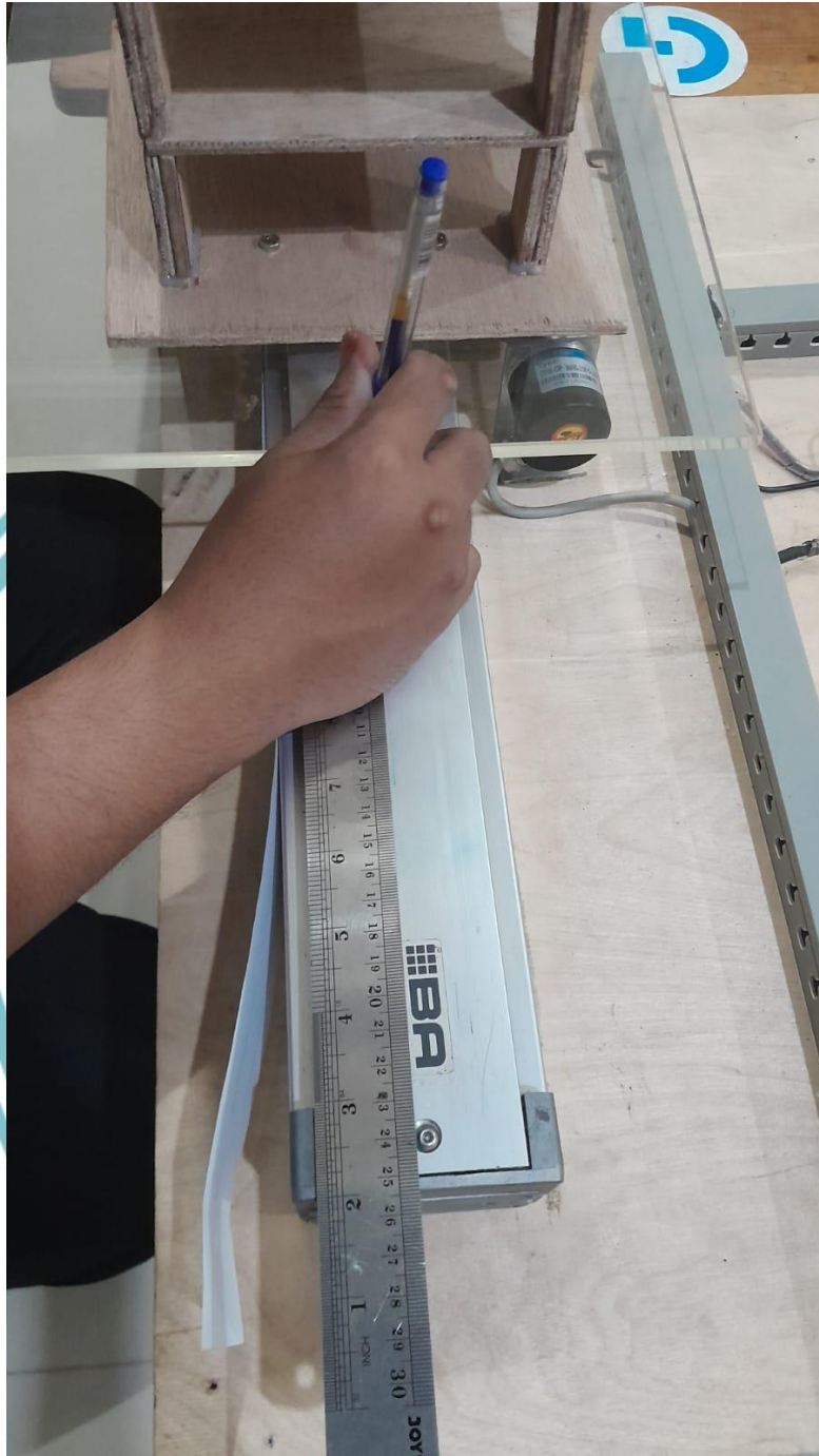
Gambar 1. Membandingkan Spesifikasi Perubahan Posisi Linear Guide Block dengan Hasil Pembacaan Sensor dengan Pengukuran Mistar
