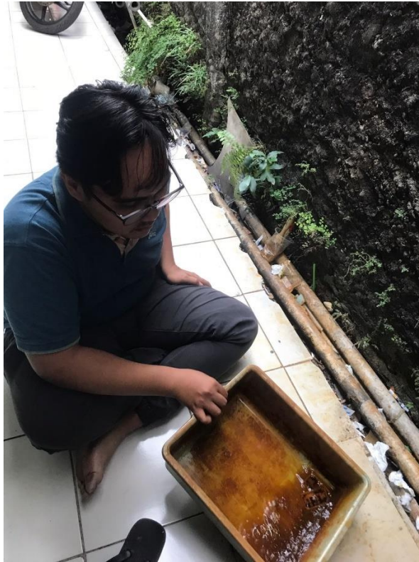
Proses etching PCB untuk PowerSupply
