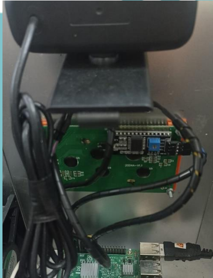
Gambar 4.10 Raspberry pi terhubung dengan webcam
