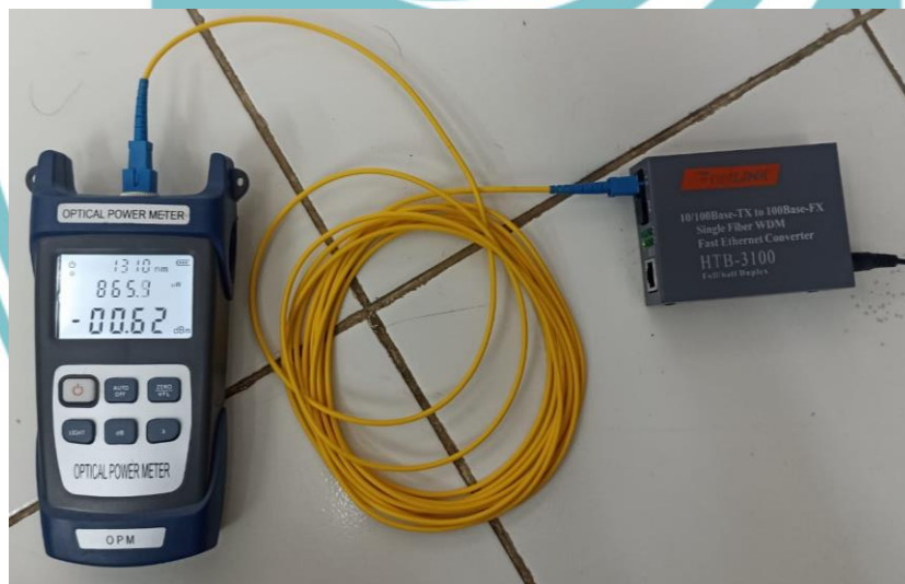
Gambar 4.16 Pengujian redaman fiber optik
