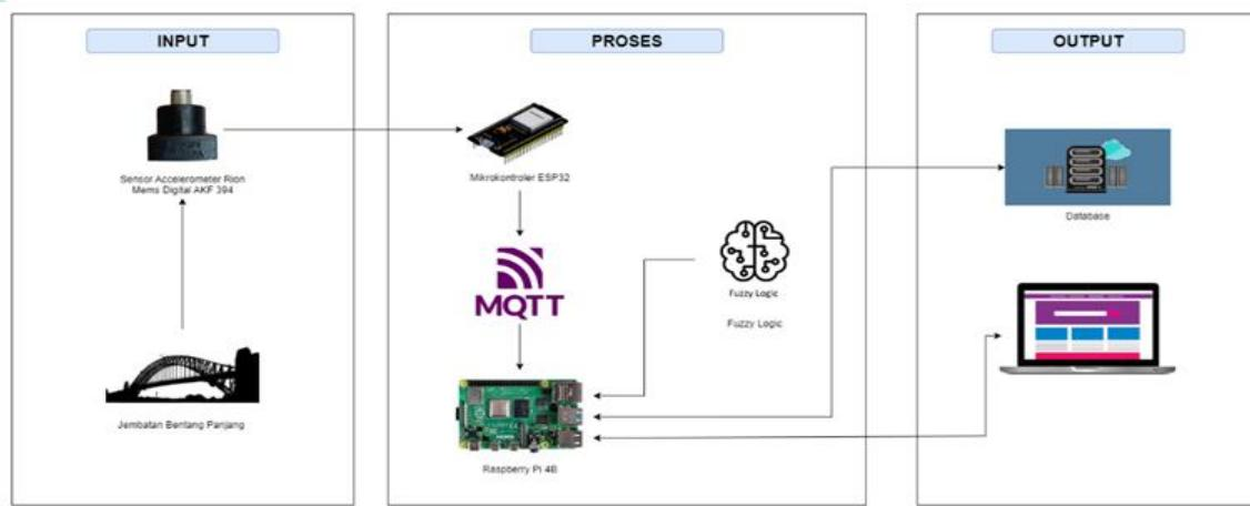
Gambar 3. 1 Diagram Blok
