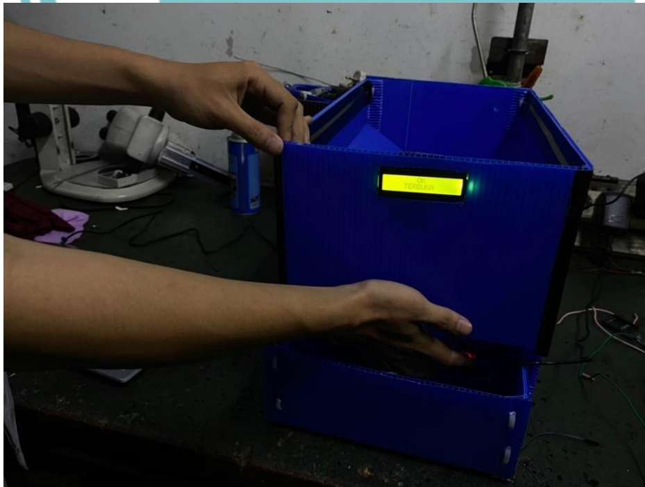
Gambar L- 2 Foto Box Part Segregation dengan notif pada LCD
