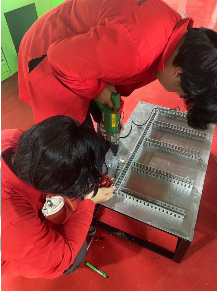
Proses pembolongan dibagian plat untuk posisi komponen push button, buzer, emergency, lampu indikator dan selector switch
