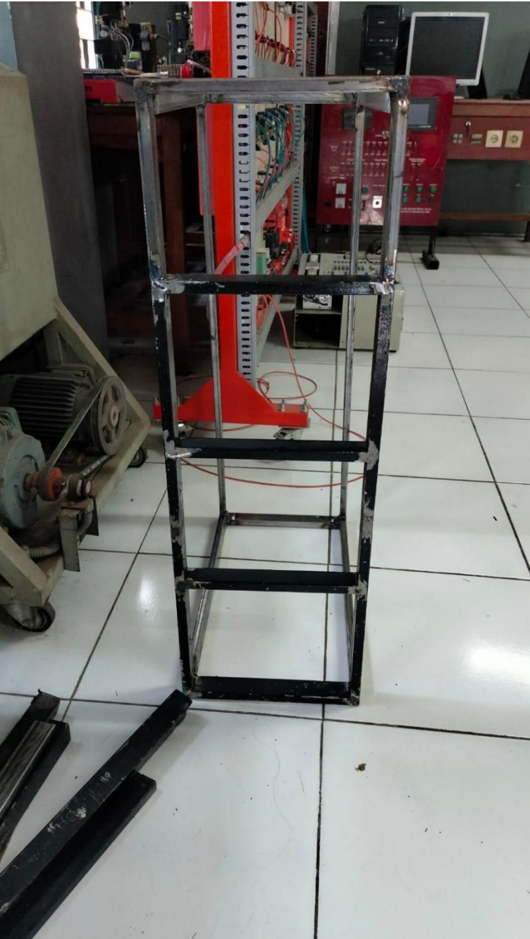
Bagian depan rangka elevator setelah di las
