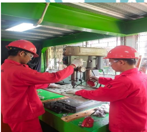
Pengeboran pintu panel
