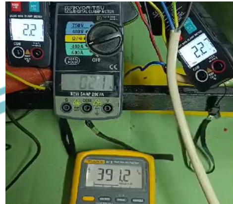
Pengukuran tegangan dan arus saat motor induksi beroperasi
