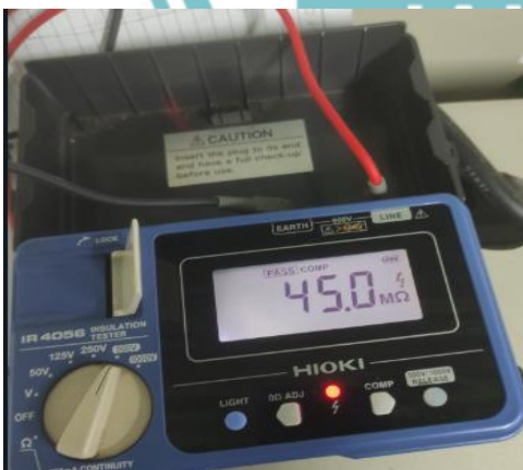
Pengujian nilai tahanan isolasi
