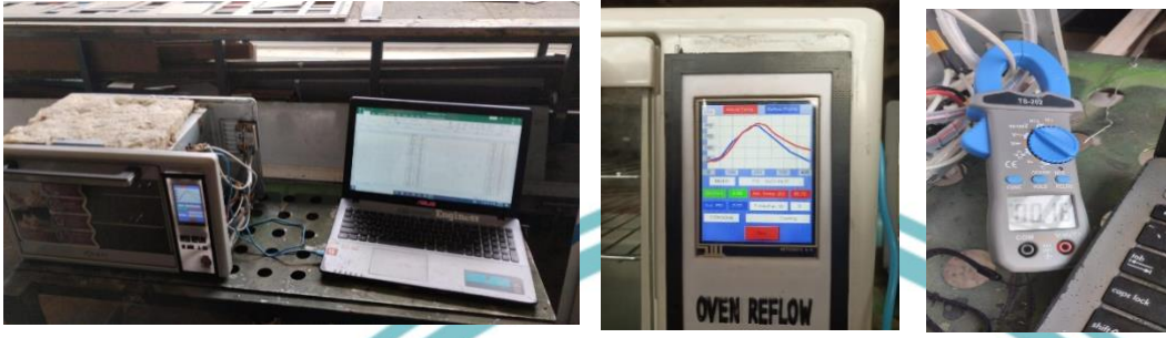
Gambar L.3 Pengujian Tuning PID dan Pengukuran Ampere pada heater Sumber : Dokumentasi Pribadi
