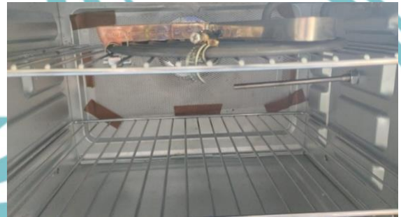
Gambar L.1 Gambar Alat Oven Reflow Sumber : Dokumentasi Pribadi
