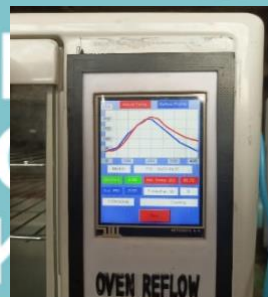
Gambar L.2 Pengujian Reflow dengan Logika Fuzzy dan Pengukuran Ampere pada heater
