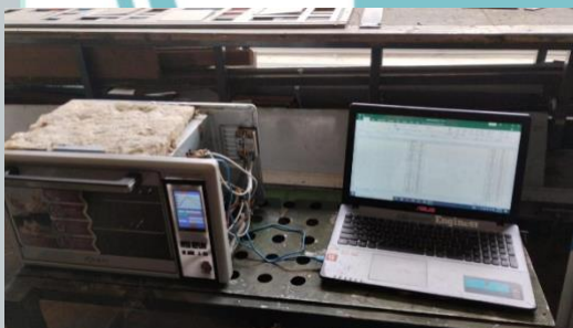
Gambar L.2 Pengujian Reflow dengan Logika Fuzzy dan Pengukuran Ampere pada heater
