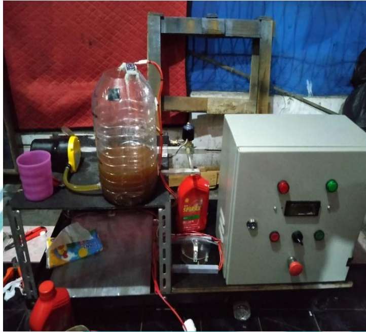
Lampiran 2. 1 Prototipe Mesin Filling Oli Berbasis Arduino Uno (sumber: dokumen pribadi)
