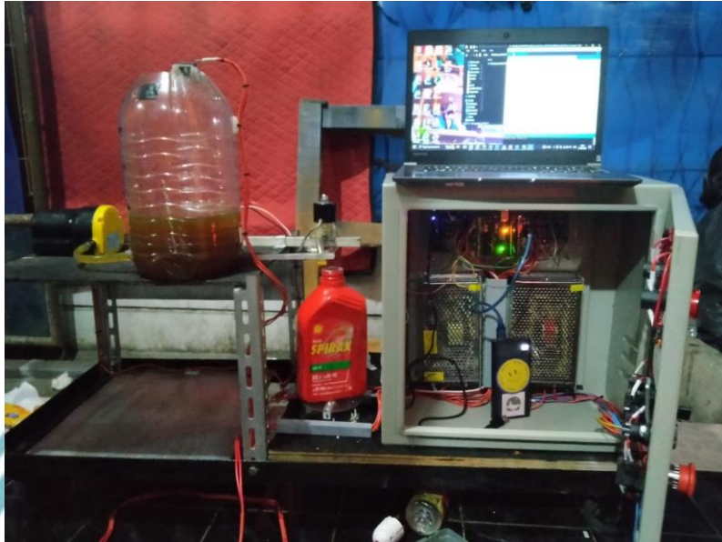
Lampiran 2. 3 Prototipe Mesin Filling Oli Berbasis Arduino Uno (sumber: dokumen pribadi)
