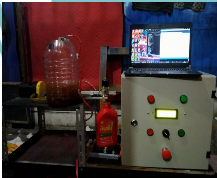
Lampiran 2. 2 Prototipe Mesin Filling Oli Berbasis Arduino Uno (sumber: dokumen pribadi)
