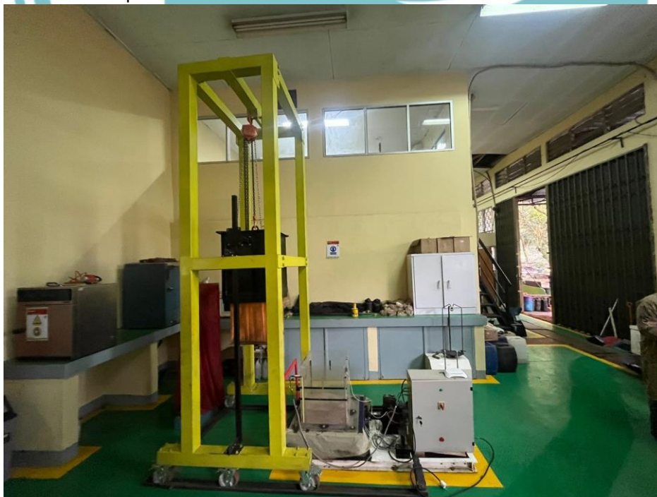
Dokumentasi Alat Simulator Likuefaksi Tanah pada Lab Tanah Jurusan Teknik Sipil
