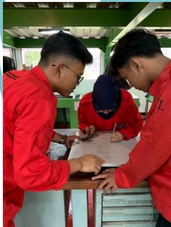
Lampiran 7 Penitikan bagian panel yang akan di bor
