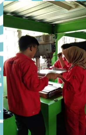
Lampiran 8 Pemboran bagian panel yang akan diletakkan komponen
