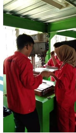
Pemboran bagian panel yang akan diletakkan komponen
