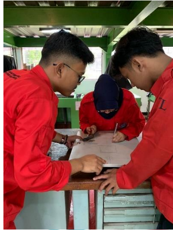
Penitikan bagian panel yang akan di bor
