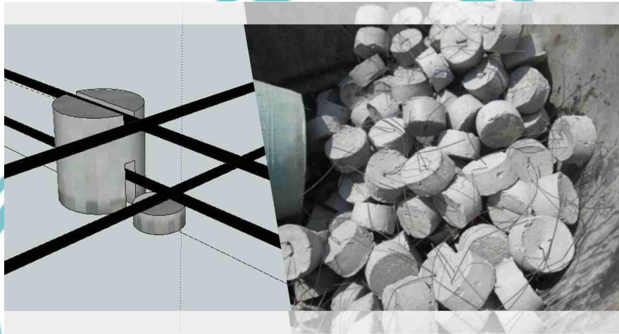
Gambar 4. 22 Beton decking (Sumber : Google)
