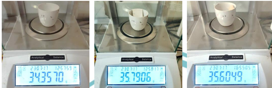
Dokumentasi Pengujian Kadar Air pada Sampel SDM3.2
