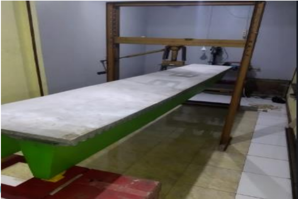
Persiapan Pembebanan sebelum diberi External stressing
