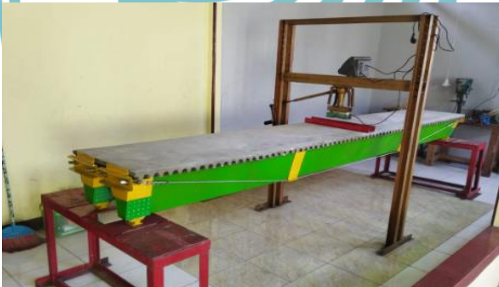
Persiapan Pengujian dengan External stressing
