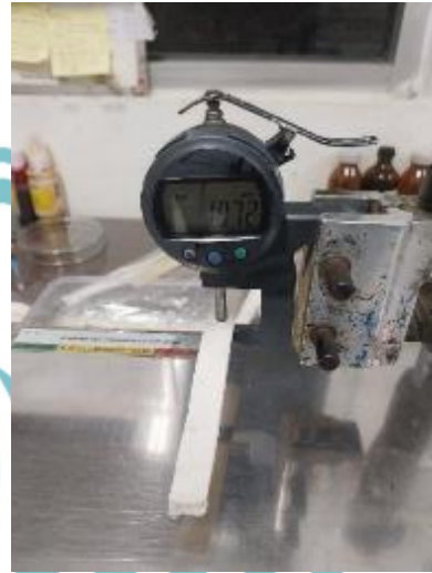
Pengukuran ketebalan menggunakan thickness gauge
