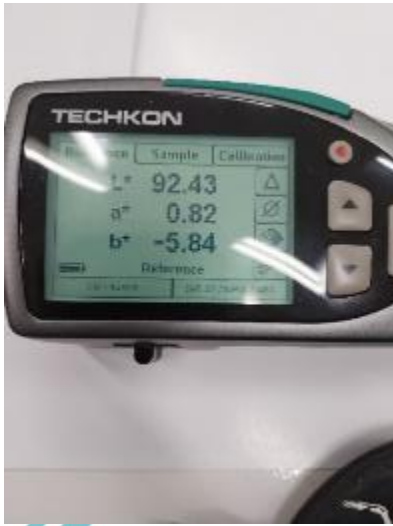
Pembacaan parameter warna biofoam pada alat spektrodensitometer
