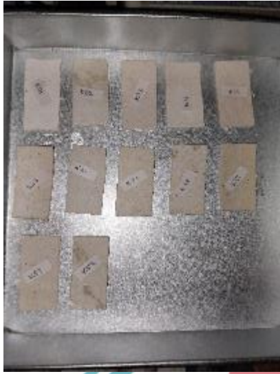
Sampel daya serap setelah dicelupkan ke dalam air selama 1 menit
