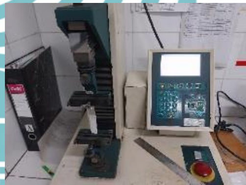
Pengujian kuat tarik menggunakan mesin UTM
