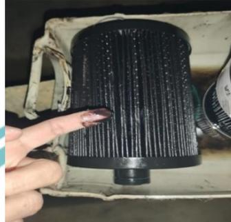
Gambar 1. Pembentukan gelling/deposit pada penyaring bahan bakar B30
