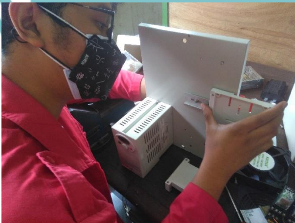
Pemasangan Komponen ke Rel
