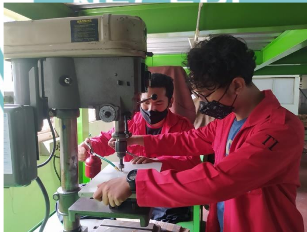
Pengeboran Pintu Panel
