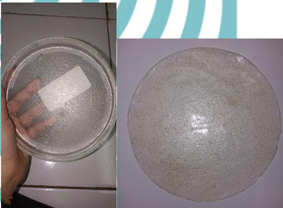
Larutan bioplastik yang sudah homogen kemudian dicetak di cawan petridis dan di oven pada suhu 70°C.
