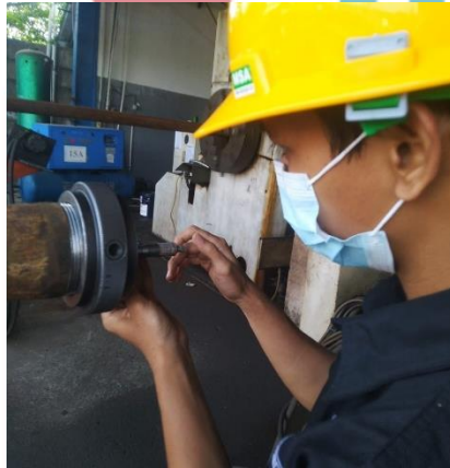
Foto diatas adalah kegiatan penulis melakukan inspeksi thread Pipa 3-1/2" yang baru selesai dibubut.
