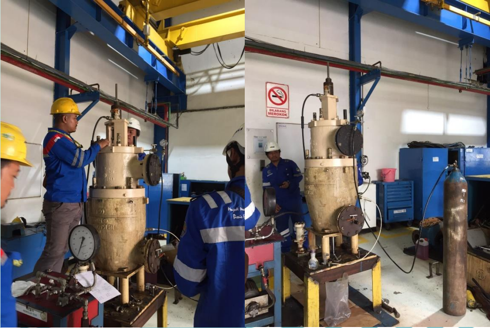
Gambar 5 Preventive Maintenance - Pengetesan Kebocoran pada GCV
