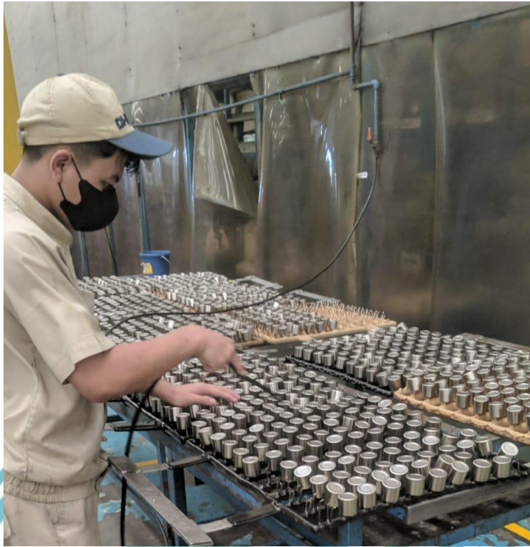
Lampiran 2 Proses Pembersihan dan Penyortiran Piston Caliper Setelah di-Plating
