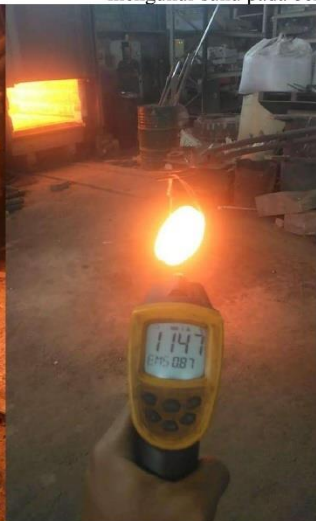
mengukur suhu pada benda kerja sebelum di quenching
