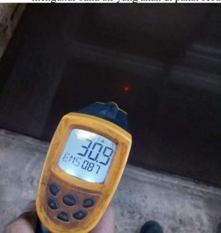
mengukur suhu pada benda kerja sebelum di quenching
